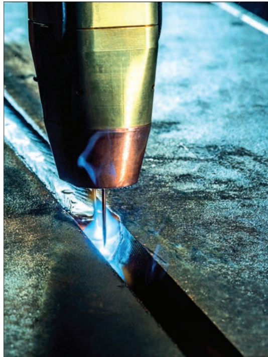
Вдосконалений механізм охолодження пальника системи TPS/i TWIN Push збільшує термін служби зношуваних деталей
