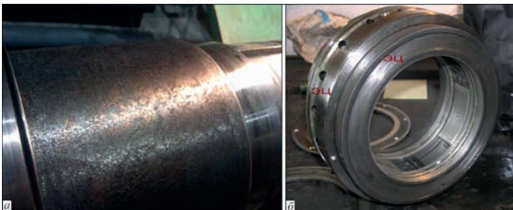
Рис. 4. Зовнішній вигляд захисної втулки вузла ущільнення після ЕІЛ (а) і кільце плаваючого ущільнення відцентрового компресора (б)
