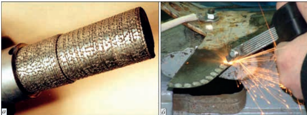
Рис. 3. Зміцнення деталей методом ЕІЛ з застосуванням розроблених електродів: шийка ротора електродвигуна з боку півмуфти (а) та леміш плуга (б)
