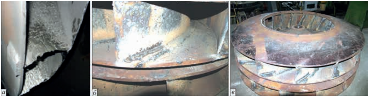
Рис. 5. Зношена (а) та наплавлена (б) лопатка колеса млинового вентилятора, відновлені колеса млинового вентилятора ВМ 100/1200 (в)
