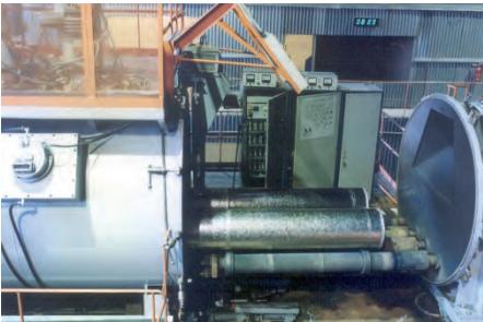
Електронно-променева установка UE185 для оплавлення поверхні зливків
