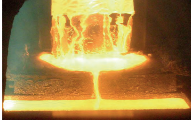
Виправка зливка-сляба 165×950×2500 мм титанового сплаву ПТ-3В
