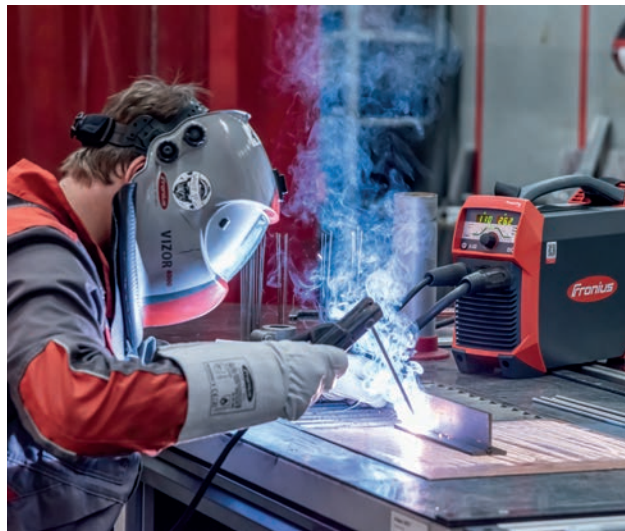
Окремі функції систем TransTig 170 і TransTig 210, зокрема Anti-Stick, HotStart, зниження струму та імпульсне зварювання, забезпечують чудовий результат під час зварювання електродом
