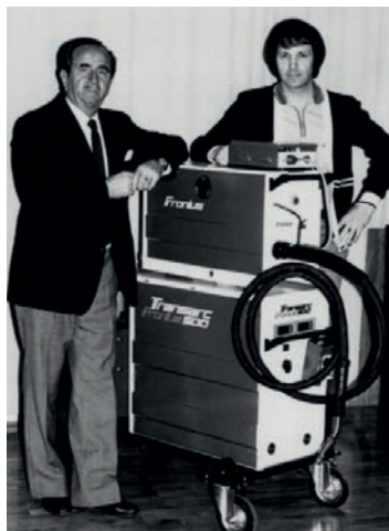
Fronius Transarc 500: перша у світі інверторна зварювальна система
