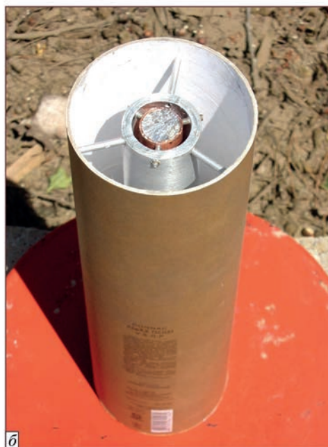
Рис. 1. Схема збірки під зварювання вибухом для отримання біметалічної трубної заготовки (а) та заготовки під зварювання вибухом зі сталевим стрижнем, залитим сплавом Вуда всередині мідної трубки (б)
