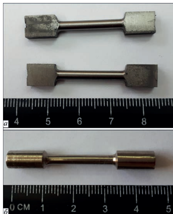
Рис. 1. Зовнішній вигляд зразка інтерметаліду, який виготовлений для механічних випробувань: а – товщина 3; б – 10 мм
