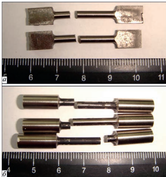
Рис. 2. Зразки інтерметаліду після випробування на розтяг: а – товщина 3 мм; б – 10
