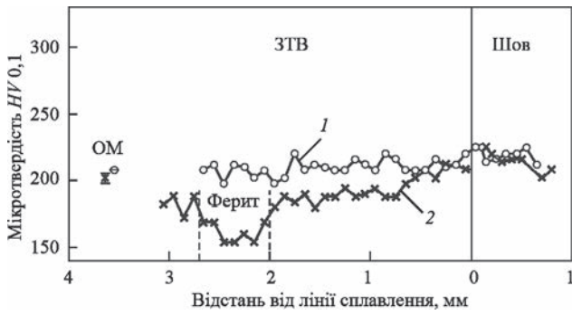
Рис. 8. Вимірювання мікротвердості в однопрохідному з'єднанні сталі ПЗ з різним розміром зерен в стані після відпуску 750 °С, 18 год (1 – велике зерно; 2 – мале)
