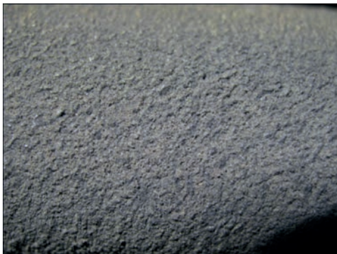
Рис. 12. Макроструктура напилених труб після шести років експлуатації
