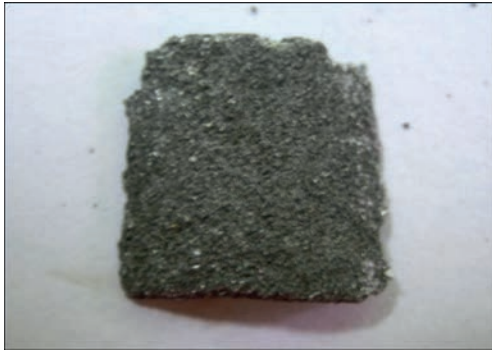
Рис. 11. Відшарований шар після випробування на сплющування
