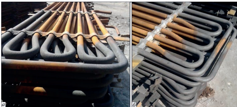
Рис. 6. Зовнішній вигляд напилених змійовиків
