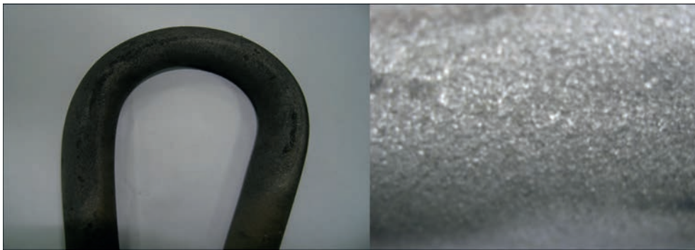
Рис. 7. Зовнішній вигляд згину труби та її поверхні після напилення
