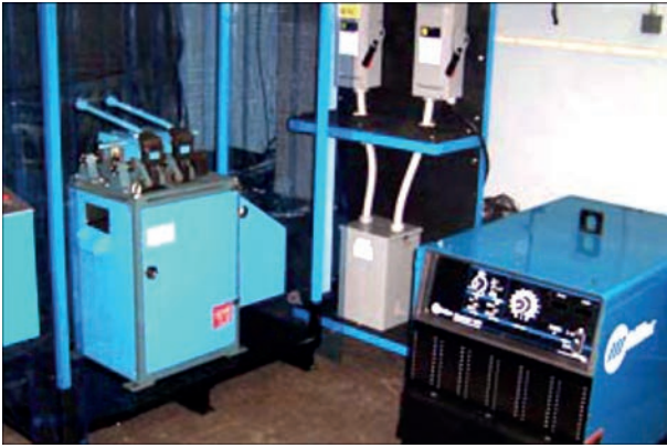
Рис. 2. Машина МД-101 для ПЗМД зварювання труб
