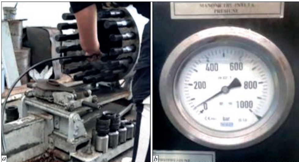
Рис. 9. Гідравлічні випробування: а – зразок труби із заглушками для гідравлічних випробувань; б – покази тиску на манометрі
