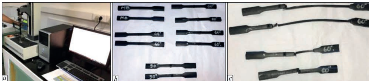
Рис. 7. Визначення механічних властивостей випробуванням на розтяг: а – експериментальна установка для випробувань на розтяг; б – вигляд зразків перед випробуванням на розтяг; с – порівняння вигляду деяких зразків після проведення випробування на розтяг
