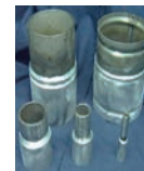
Трубчасті з'єднання Al + stainless steel IC 321
