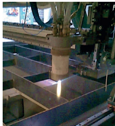
Зовнішній вигляд обладнання для плазмового різання на зворотній полярності
