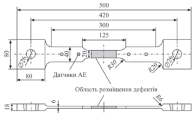
Рис. 3. Зразок для проведення випробувань з застосуванням АЕ технології
