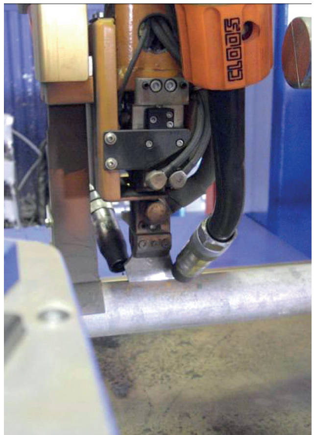
Орієнтація двох зварювальних пальників назустріч один одному
