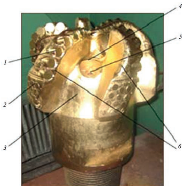
Рис. 1. Схема розташування робочих органів долота: 1 – різець; 2 – твердосплавна вставка калібруючої поверхні; 3 – міжлопатевий простір для виносу шламу; 4 – захисне покриття промивного каналу; 5 – твердосплавна насадка промивного каналу; 6 – захисне покриття робочих органів лопатей
