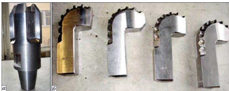
Рис. 5. Комбіноване долото: а – корпус; б – лопаті
