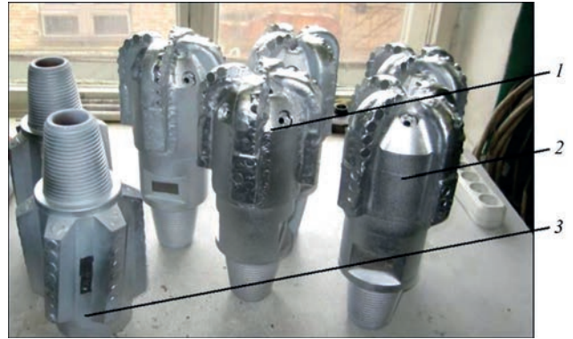
Рис. 8. Бурові долота із захисним покриттям: 1 – комбіноване; 2 – цільнофрезероване; 3 – калібратор
