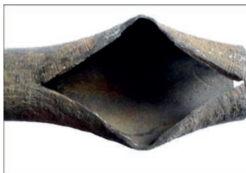
Рис. 1. Руйнування паропроводу зі сталі 12X1MФ по механізму повзучості. Ресурс 276 тис. год.
