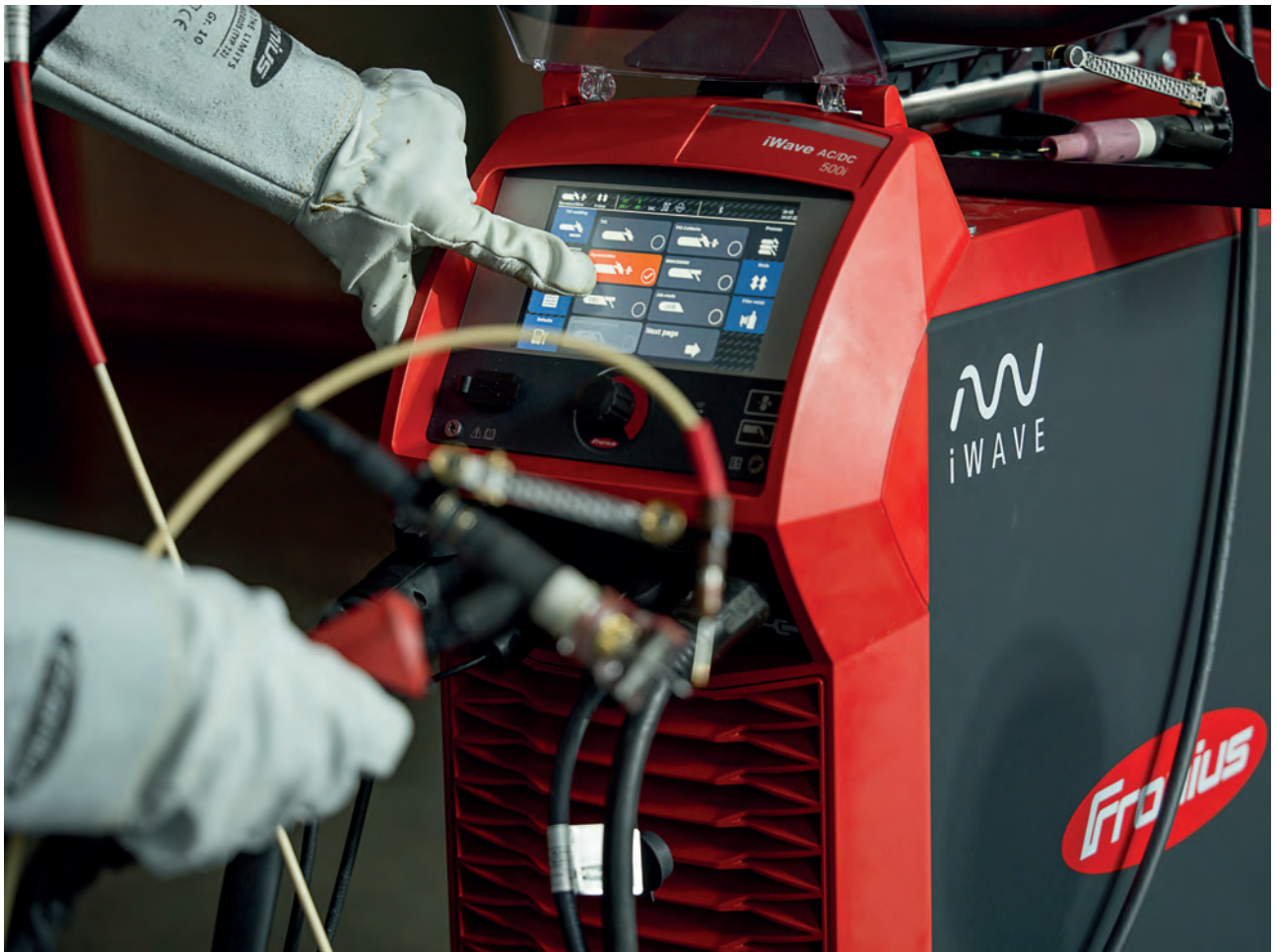
Автоматичне регулювання пристрою подавання дроту за допомогою зварювального комплекту TIG DynamicWire
