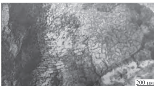
Рис. 5. Розподіл дислокацій в металі ділянки неповної рекристалізації ЗТВ зварного з'єднання зі сталі 12Х1МФ. \epsilon = 4\% , напрацювання 280 тис. год [6]
