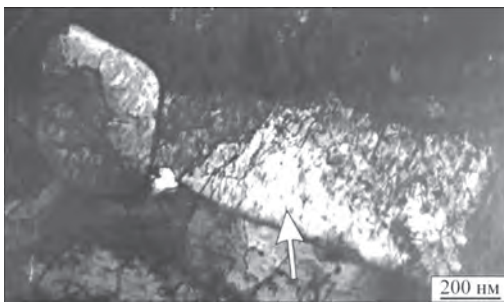
Рис. 11. Мікроструктура металу шва зварного з'єднання зі сталі 12X1МФ. Ділянка зерна \alpha -фази із зменшеною щільністю дислокацій відзначена стрілкою. Ресурс 280 тис. год
