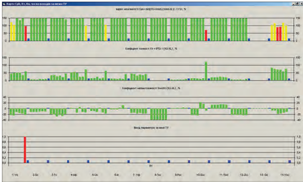
Рис. 4. Результати розрахунків Срк, пХout, Кн, Кт для окремої плити (6 примірників), кожна з яких нараховує близько 40 стиків разом з контрольними зразками, вибірки протягом 2013–2020 рр. на машині К-1000
