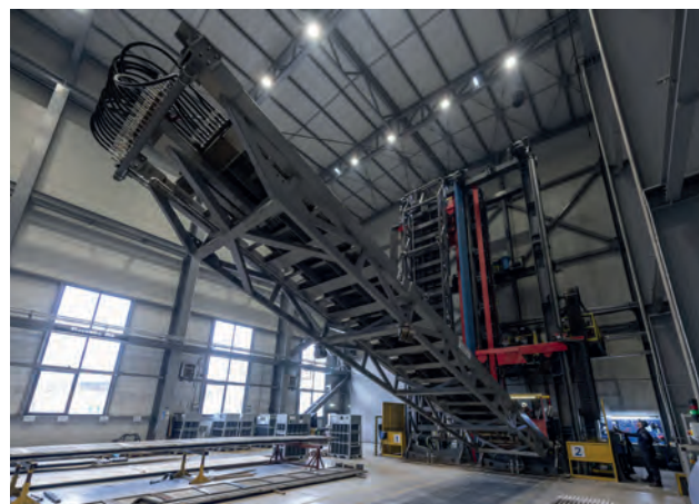
Механізована колона для плакування з використанням методу СМТ: ребристі стінки зафіксовано, вигляд із платформи
