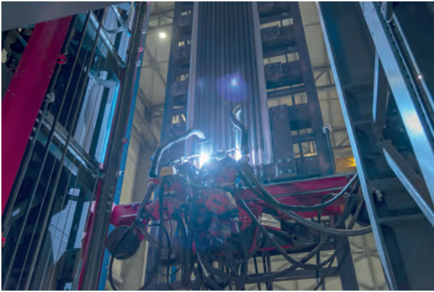
Механізована колона для плакування з використанням методу СМТ: процес плакування
