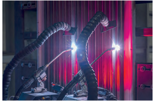
Механізована колона для плакування з використанням методу СМТ: зварювальні пальники з димовідведенням
