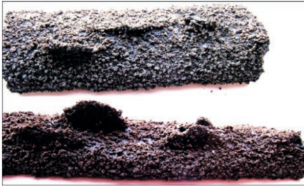
Рис. 3. Нерівності на поверхні шлакової кірки, що виникають при надмірному віддаленні ХД від останнього електрода безпечивши їх високу ударну в'язкість (табл. 5). Для подальшого підвищення ударної в'язкості металу швів може бути застосоване додаткова легування Ті–В.
