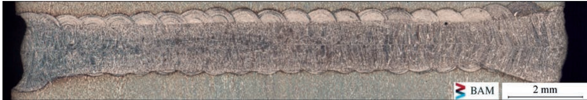
Fig. 4. Microsection of weld seam with LMD-tacking Рис. 4. Макрошліф зварного шва після плакування
