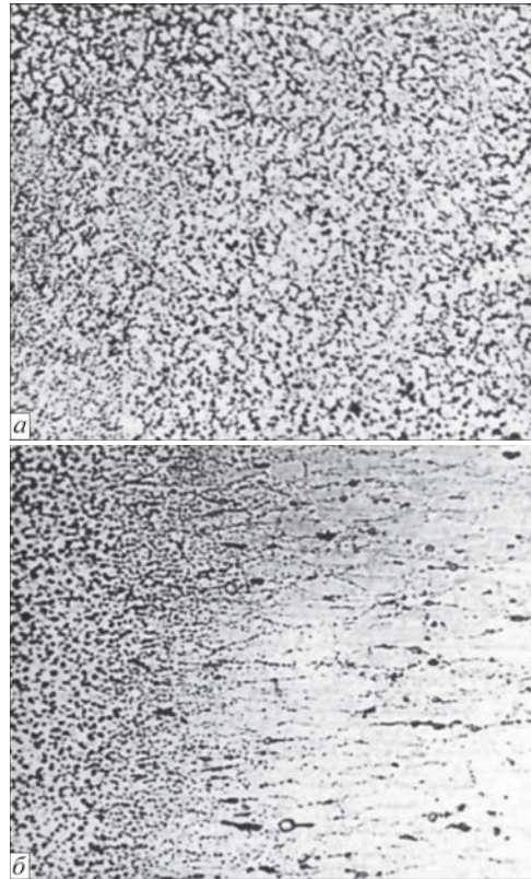
Рис. 3. Мікроструктура ( \times 200 ) металу зварного шва штампованого напівфабрикату сплаву 1570: а – центральна частина шва; б – лінія сплавлення
