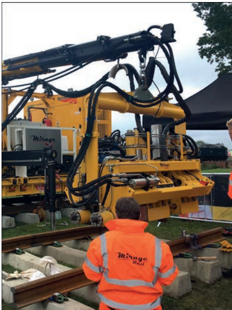
Рис. 10. Індукційний зварювальний робот фірми Mirage Rail електронної вимірювальної системи. Струмопідведення повністю незалежне від затискання і здійснюється по зовнішній стороні головки рейок і їх ніжки. Маса та габарити машини AMS200 не перевищує масу машини AMS60.
