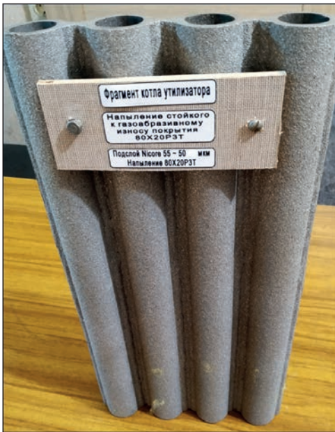
Рис. 5. Фрагмент поверхні охолодження котла-утилизатора
