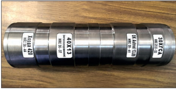
Рис. 9. Зразок-імітатор вісі колісної пари
