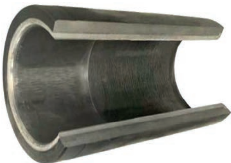
Рис. 6. Зовнішній вигляд наплавленої втулки діаметром 160 мм
