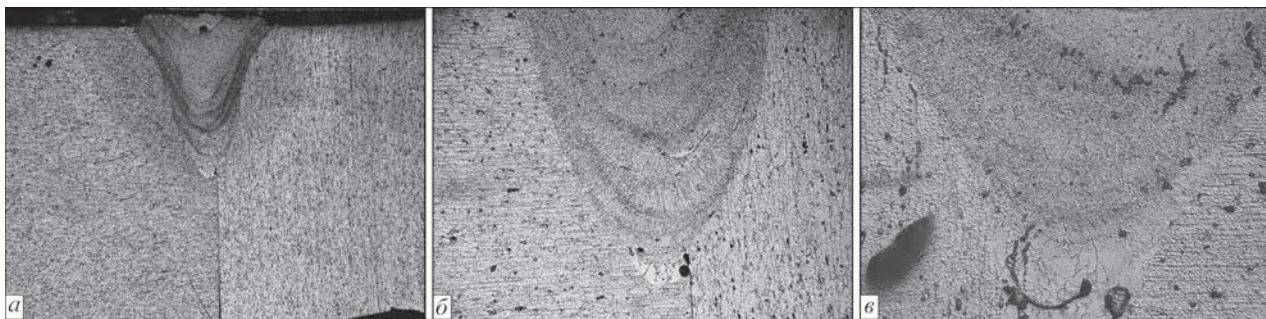
Рис. 6. Мікроструктура з'єднань сплаву 7075, отриманих лазерним зварюванням: а – загальний вигляд проплавлення, \times 20 ; б – пори в кореневій зоні, \times 250 ; в – стрічкові виділення оксидного типу в кореневій зоні, \times 500
