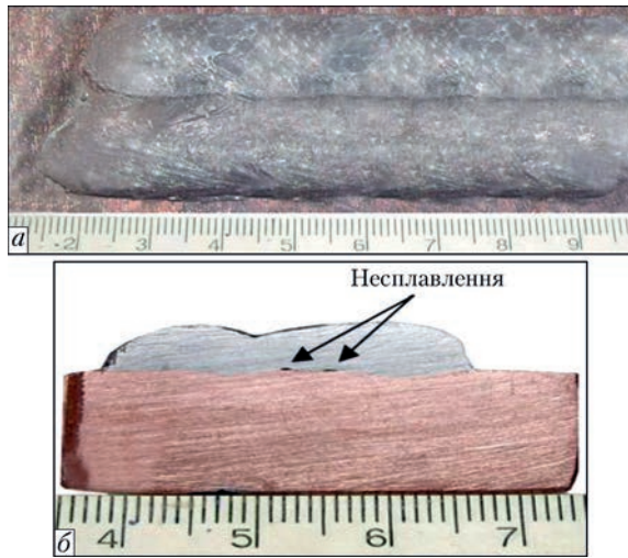
Рис. 1. Зовнішній вигляд валиків, наплавлених на зразок з міді М1 порошковим дротом № 1 (тип наплавленого металу 25Х5ФМС) (а) та макрощліф їх поперечного перерізу (б)
