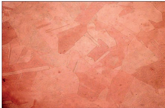
Рис. 2. Мікроструктура (×200) міді, яка використовувалась у якості основного металу
