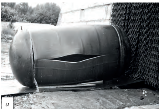
Рис. 8. Натурні випробування криволінійних труб класу Х70: а – ділянка труби діаметром 1420 мм (з привареними заглушками), отриманими за технологією ЕТЗ, після натурних гідравлічних випробувань; б – криволінійна ділянка труби вилучається з укриття безпосередньо після руйнування під час гідравлічних випробувань
