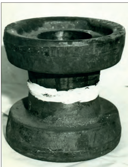
Рис. 3. Каток роликів опорної гусениці для виробу типу Т-150, отриманий за технологією індукційного зварювання
