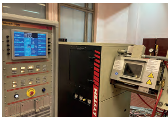
GLEEBLE-3800 (DSI, США). Автоматизована динамічна система для моделювання (імітації) термодеформаційного стану металів
