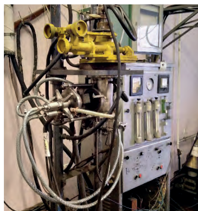
Плазмово-дугова піч (лабораторна) для плавки металів та сплавів
