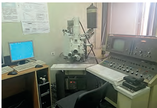
JSM-840 (JEOL, Японія). Растровий електронний мікроскоп із системою аналізу ( Link systems, Англія ) призначений для вивчення структури, топографії поверхні, характеру руйнування, мікроскопічної хімічної неоднорідності та елементного складу металевих та неметалевих матеріалів
