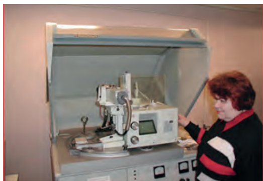
ДРОН-3, УМ-1. Дифрактометр для кількісного та якісного рентгеноструктурного фазового аналізу, визначення типу кристалічних решіток та дефектів пакування
