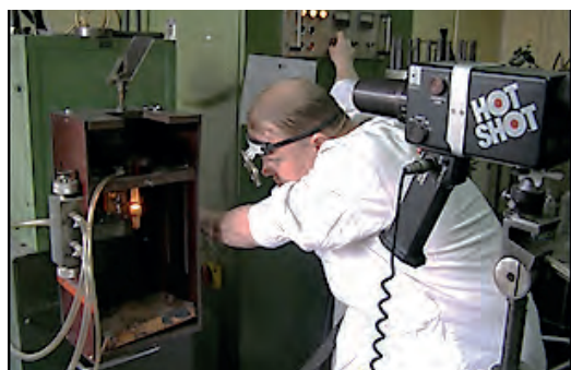
Устаткування для безтигельної (левітаційної) плавки
