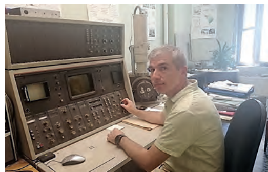
SEM-515 (Philips, Нідерланди). Скануючий електронний мікроскоп, оснащений енергодисперсійним аналізатором хімічних елементів Link Systems для фазового аналізу поверхонь.
