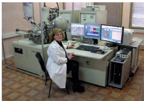
JAMP-9500F (JEOL Ltd, Японія). Оже-мікросонд з польовим емісійним катодом, укомплектований енергодисперсійним спектрометром OXFORD EDS INCA Energy 350 для аналізу елементів від берилію до урану
