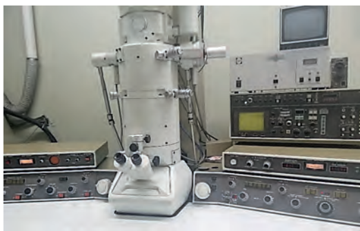
JEM-200CX (JEOL, Японія). Трансмісійний електронний мікроскоп, укомплектований ССД камерою Gatan , дозволяє досліджувати тонку структуру та фазовий склад матеріалів
