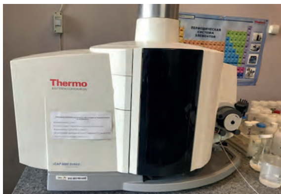
ICP-спектрометр ICAP 6500 DUO (Thermo Fisher Scientific, США). Емісійний спектрометр з індуктивно-зв'язаною плазмою для аналітичних досліджень атомного складу широкого спектру неорганічних матеріалів
