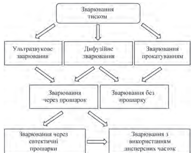
Рис. 1. Основні методи зварювання тиском магнієвих сплавів
