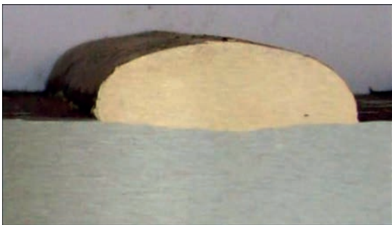
Рис. 7. Макрошліф поперечного перерізу наплавленого валика бронзи на оптимальних режимах (×2)
