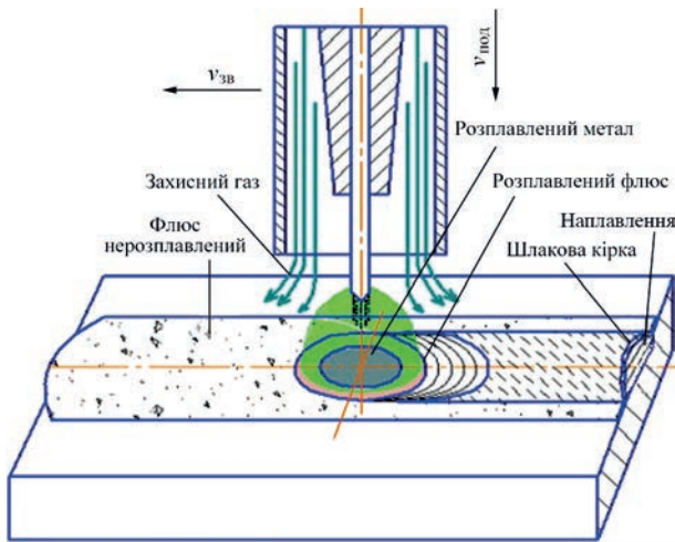
Рис. 1. Схема процесу наплавлення з комбінованим газозлаковим захистом
