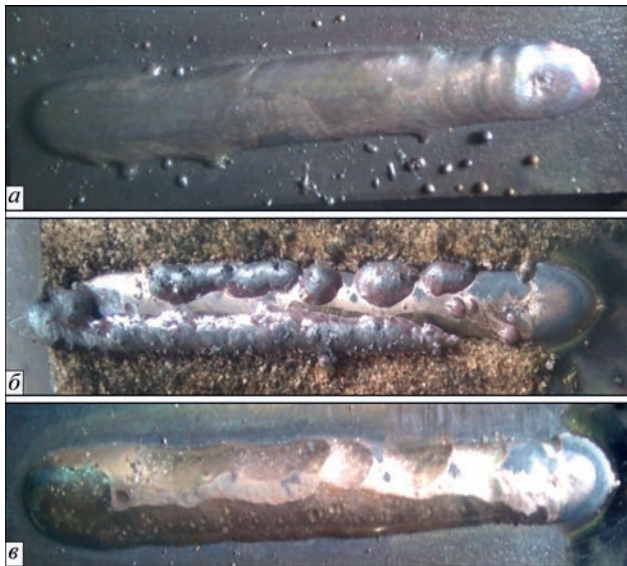
Рис. 4. Зовнішній вигляд наплавлених валиків: а – наплавлення в аргоні; б – аргон + 4,0 мм флюсу АН-60 СМ; в – аргон + + 6,0 мм флюсу АН-60СМ
