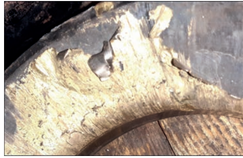
Рис. 2. Налипання матеріалу заготовки Л68 на матрицю зі сталі 3ХЗМЗФ
