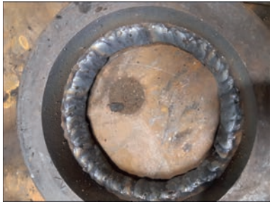
Рис. 3. Загальний вигляд наплавленої матриці зі сталі 3Х3М3Ф для пресування, виконане сплавом 50Х6В2ГСМФА в три шари кругом
