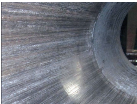
Рис. 1. Мікрорізання заготовкою з Л68 робочої поверхні прес-втулки зі сталі 38ХНЗМФА внаслідок її недостатньої твердості
