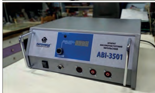
Рис 10. Зовнішній вигляд дослідного зразка-прототипу апарату ABI-3501
