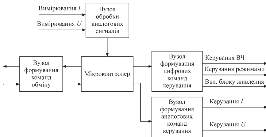
Рис. 6. Схема блоку керування силовими модулями ВЧ (вузол формування аналогових сигналів)
