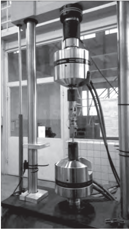
Рис. 2. Випробувальний комплекс MTS318.25 із закріпленими зразками з Zr-покриттям
