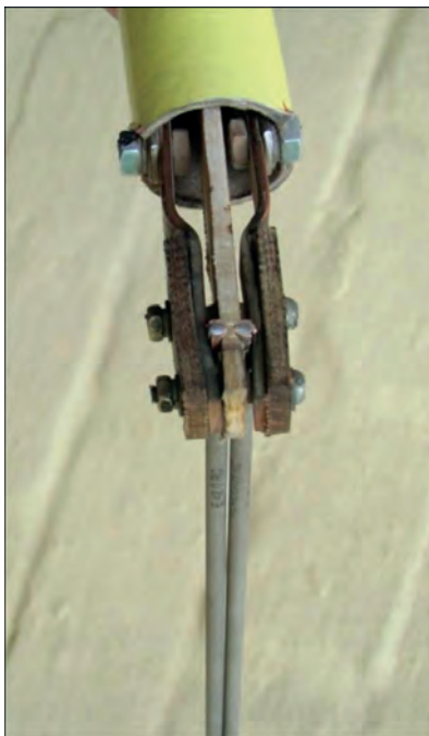
Рис. 4. Фото тримача електродів з незалежним живленням кожного із них
