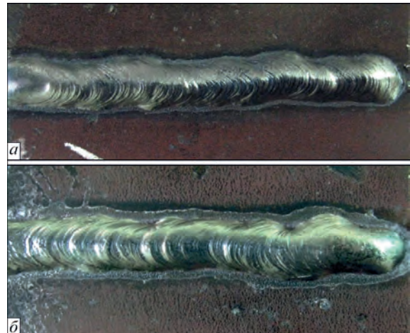
Рис. 5. Зразки наплавлення, виконані подвійними електродами з незалежним живленням кожного з них (опис. а, б – див. у тексті)
