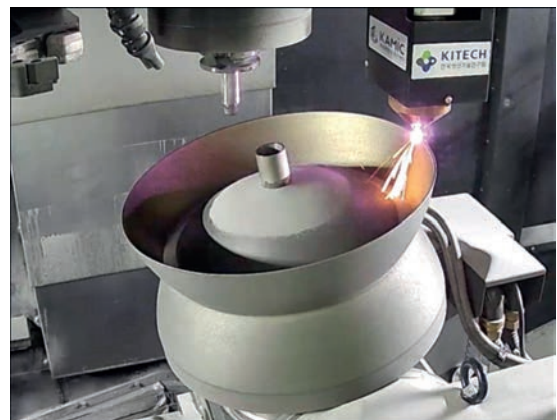
Рис. 5. Процес наплавлення паливного бака ракети-носія [21]
