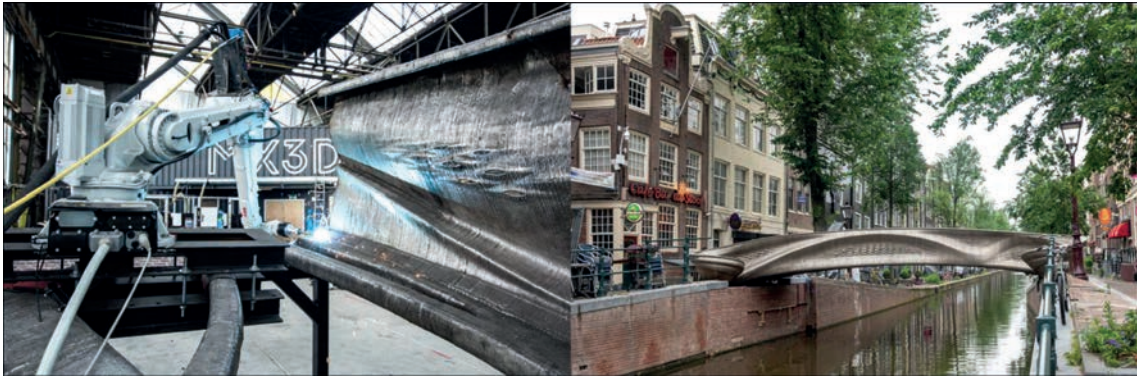
Рис. 3. Сталевий міст, створений за технологією WAAM [17]
