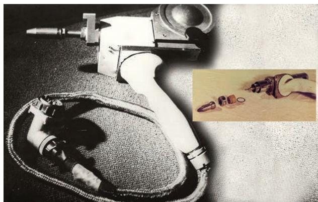
Рис. 14. Зварювальний інструмент для дугового зварювання плавким електродом
