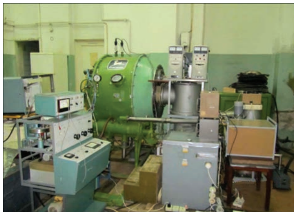
Рис. 4. Загальний вигляд обладнання для відпрацювання електронно-променевих технологічних процесів в наземних умовах
