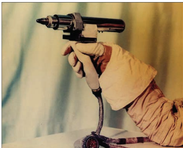
Рис. 13. Ручний інструмент для плазмово-дугового зварювання та різання у космосі
