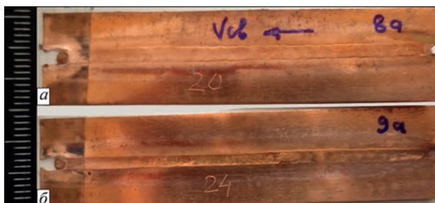
Рис. 5. Зовнішній вигляд зварних швів виконаних по технологічній схемі зварювання III при V_{\text{зв}} , м/год: а – 58; б – 70
