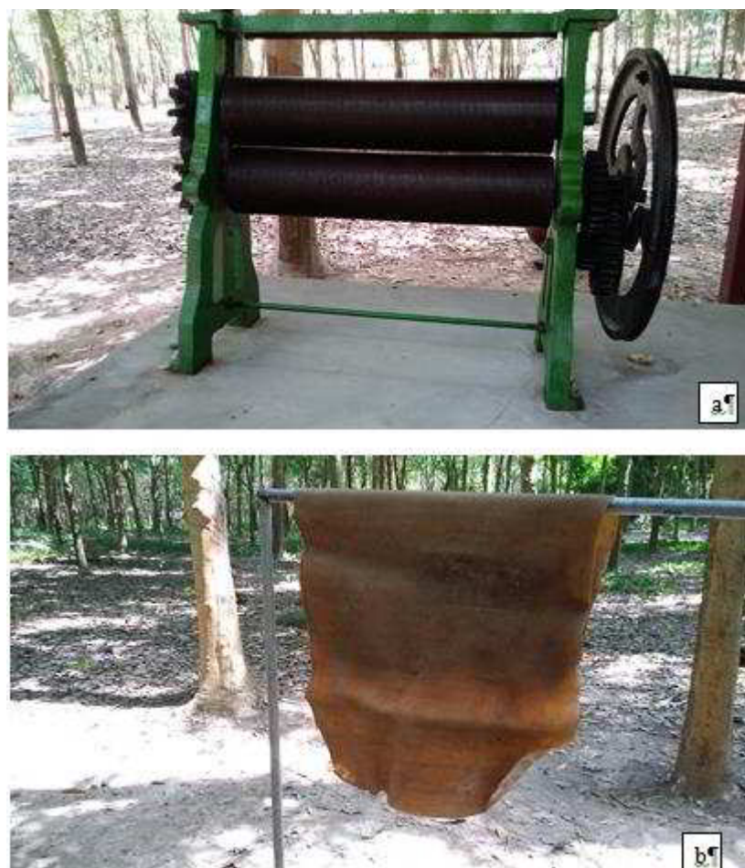
Рисунок 2. Производство каучука на о. Самуи (Таиланд), фото Т. С. Седельниковой, 2020 г.: а — оборудование для производства листового каучука; б — сушка листового каучука
