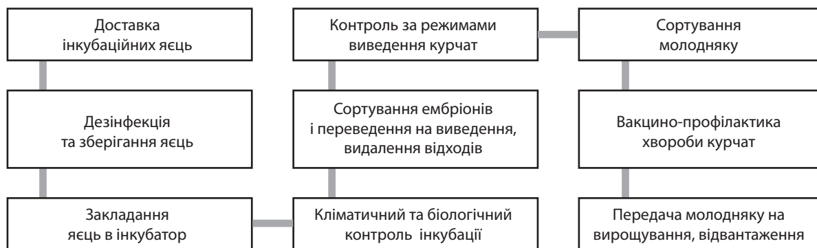
Рис. 7. Схема технологічного процесу інкубації яєць в обслуговуючому кооперативі «Пташник» [12]
