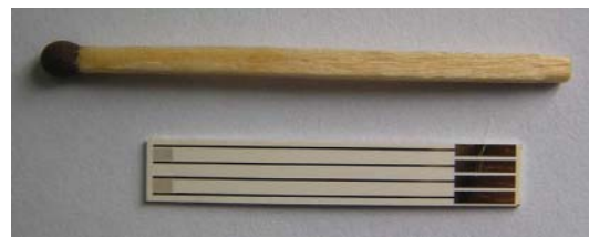
Рис. 1. Зовнішній вигляд кондуктометричних планарних гребінчастих перетворювачів
