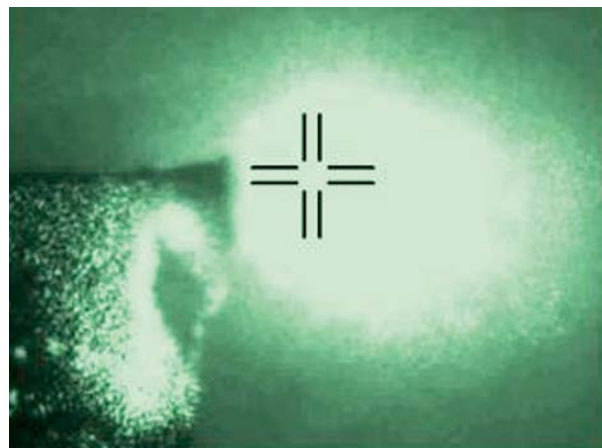
Рис. 6. «Вибух» ВНТ унаслідок опромінення в діапазоні близького ІЧ-світла 700–1100 нм [58]
