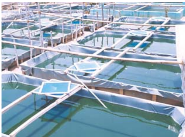
Рис. 6. Відкритий ставок для промислового вирощування водоростей
