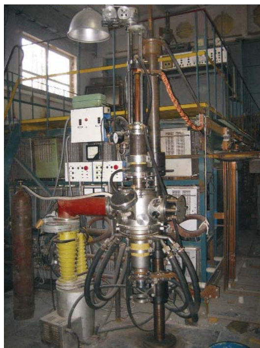
Рис. 1. Фотография установки для синтеза фуллереновой сажи
