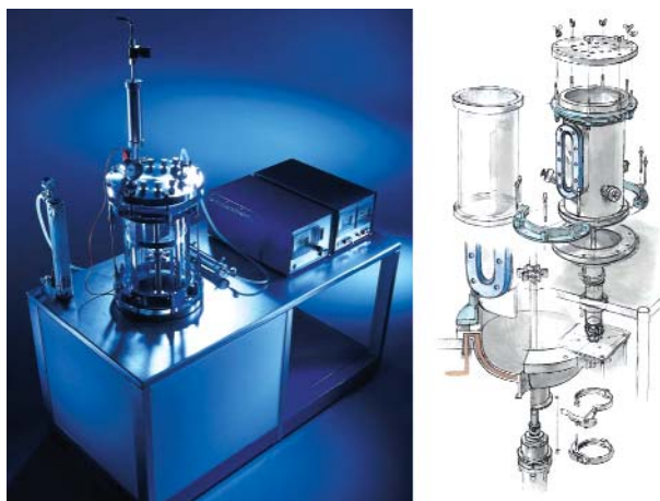
Рис. 8. Лабораторний ферментер L1523 у скляному і металевому варіантах
