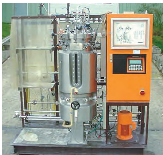
Рис. 6. Пілотний ферментер об'ємом 95 л компанії Chemar Alfa-Laval AG
