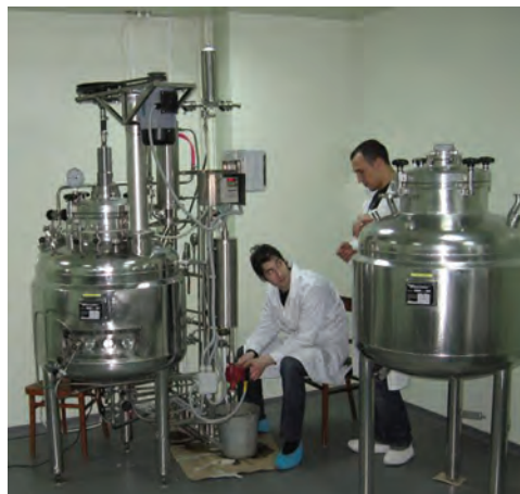
Рис. 14. Пілотний ферментер об'ємом 100 л НДІ ЗАТ «Биотехника»
