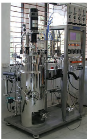
Рис. 17. Ферментер Bio S об'ємом 70 л для культивування тваринних клітин у дослідницькому центрі Bangladesh Science House
