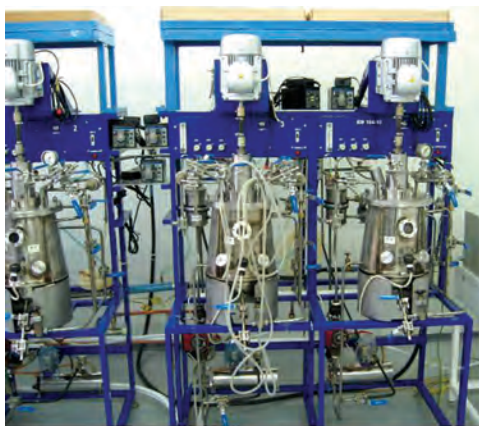
Рис. 13. Пілотний ферментер об'ємом 10 л НДІ ЗАТ «Биотехника»
