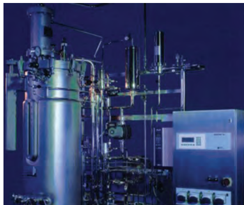
Рис. 8. Пілотна установка Biostat® D 300/D 500
