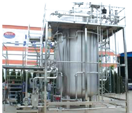
Рис. 5. Ферментер фірми Luxun I. G. (Китай, Гонконг), який встановлено просто неба
