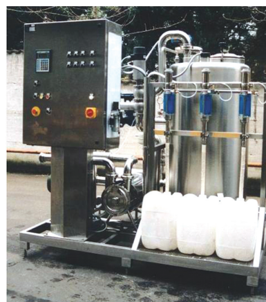
Рис. 13. SIP-станція італійської компанії Inox s.r.l.
