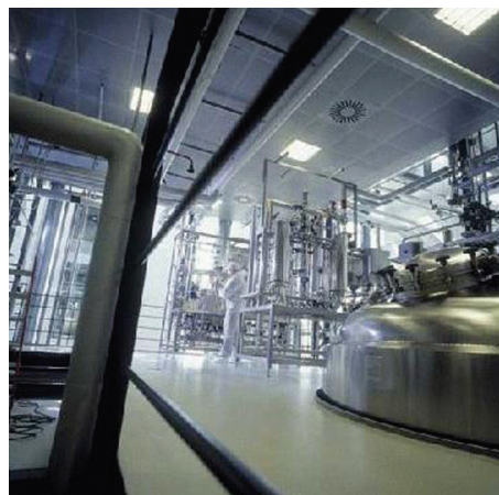
Рис. 1. Створений «під ключ» завод із тристадійною промисловою лінією, до складу якої входять ферментери компанії Sartorius Stedim Systems (Німеччина) об'ємом 360–3600–36000 л
