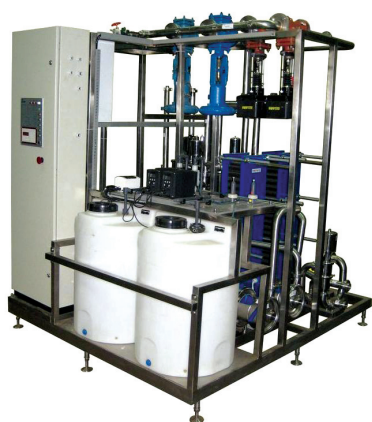
Рис. 12. SIP-станція В2-ОЦЗ-У (фірма «Экомаш», Ногінськ, Росія)
