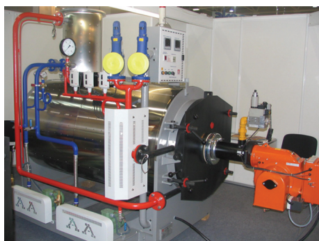
Рис. 14. Горизонтальний парогенератор серії D05 (транснаціональна компанія ALBA MAKINA)
